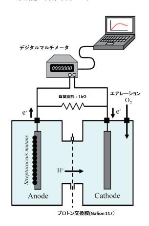
アノード側では嫌気的な環境でS. mutansが有機物を分解し、 $H^+$ が発生( $H_2 \rightarrow 2H^+ + 2e^-$ )する。プロトン交換膜は $H^+$ を選択的にカソード側に透過させる。カソード側では好気的な環境から $O_2$ の電気化学的反応により発電される( $2H^+ + 2e^- + 1/2O_2 \rightarrow H_2O$ ) Kameda et al. (2017)、Fig. 2を元に改変
